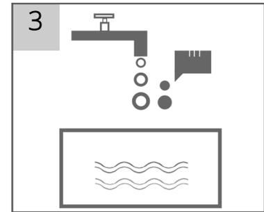
3 Das Mittel vorsichtig in benötigter Konzentration mittels Dosierpumpe in die Desinfektionswanne geben.\*
